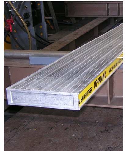
FIG.1. SCAFFOLD TEST PLANK
